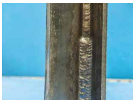
Saldatura multi passaggio - verticale
