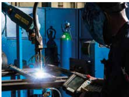
Saldatura MAG robotizzata
