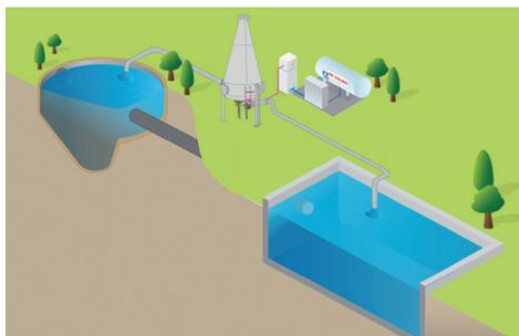
**CS-NOZZLE** o Venturi: sono sistemi di iniezione della CO<sub>2</sub> basati sulla variazione di pressione da 0,5 a 1,2 bar che provocano un effetto di espansione – dispersione per miscelare acqua e CO<sub>2</sub> gassosa. Sono impianti tubo-in-tubo.
