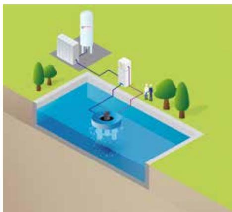
Il saturatore **BICONO** è in grado di solubilizzare l'ozono in acqua al limite di saturazione. È l'opzione migliore per un reattore a ozono in piccola scala
