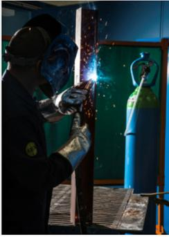
*ARCAL™ Chrome, la miscela Argon / CO2 di riferimento per la saldatura MAG di acciai inossidabili con potere ossidante controllato*
